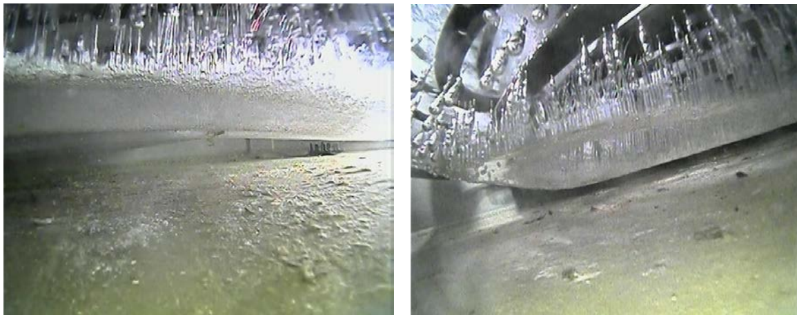
Abbildung 2-164: Eisbildung mit eingeschlossenen Luftblasen in Bodennähe am Ende der Entzugsphase
