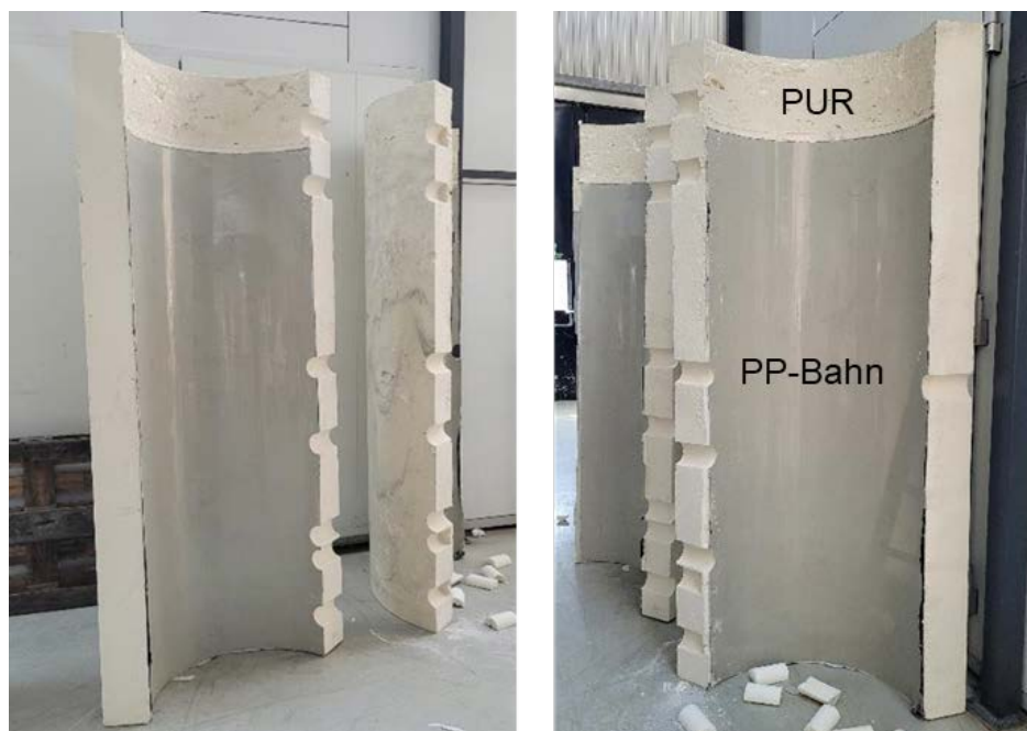
Abbildung 2-66: Manteldämmungssegmente von Wärmedämmung 2 nach der Ablösung vom Innenzylinder des Formwerkzeugs.
