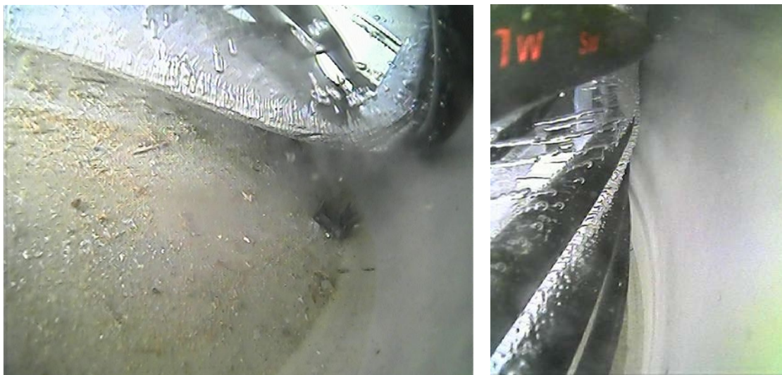
Abbildung 2-165: links: Eisbildung in der Ecke von Speicherboden und Seitenwand; rechts: Eisbildung in Wandnähe am Ende der 3. Entzugsphase.
