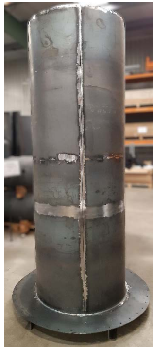
Abbildung 2-61: Innenzylinder des Formwerkzeugs für die Manteldämmung der Wärmedämmung 2
