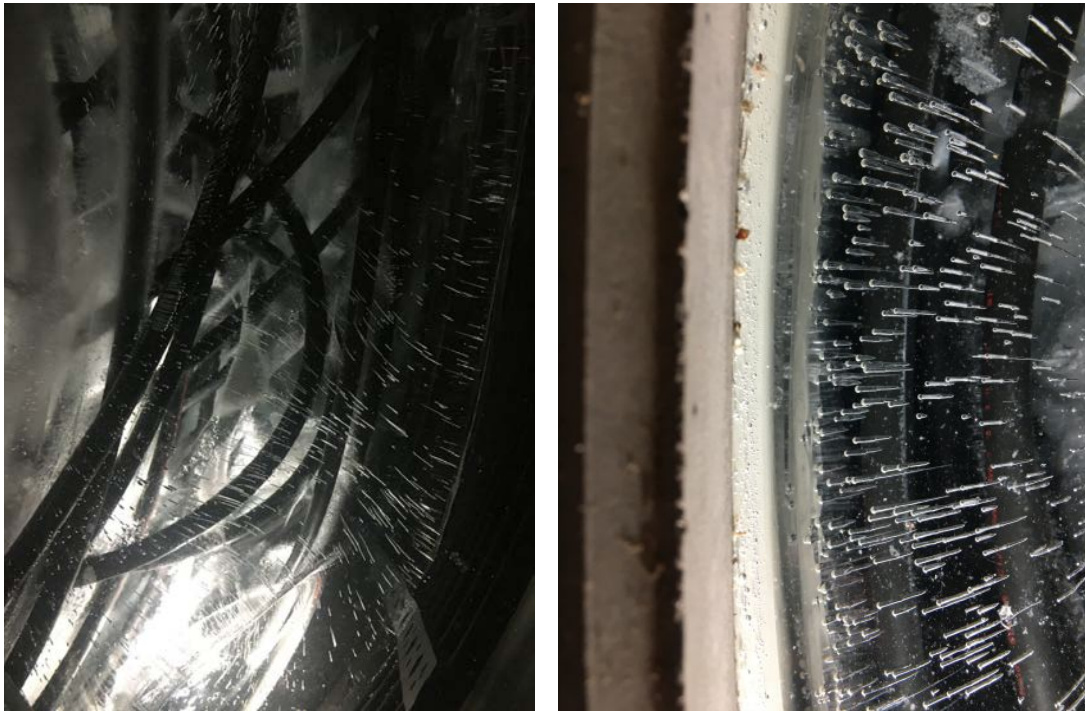
Abbildung 2-161: links: Nach der Konditionierung mit Luftblasen durchsetztes Eis am Ende der Entzugsphase nach drei Zyklen. Rechts: Eisformation in Speicherwandnähe am Ende des Entzugs mit eingeschlossenen Luftblasen und flüssigen Wasser im Spalt.
