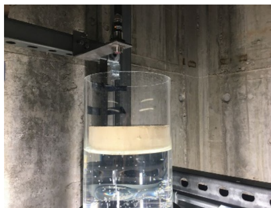
Abbildung 2-94: Polyurethan-Schwimmer in den beiden Röhren des Pegelprüfstandes.
