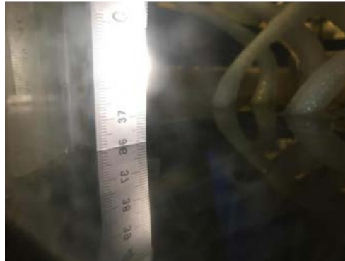
Abbildung 2-85: Bestimmung der Wasserstandshöhe im Modelleisspeicher mittels Metallmeterstab.
