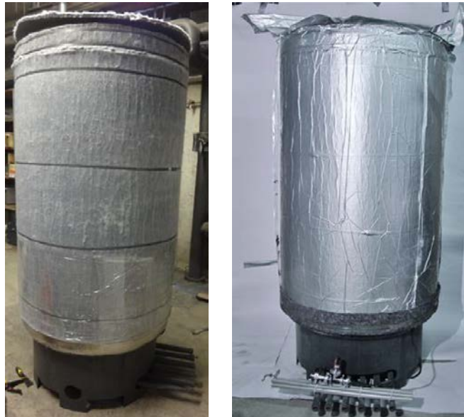
Abbildung 2-7: Folien-Dämmkonzept. Links: WWS umhüllt mit Aerogel-Dämmmatten; rechts WWS und Aerogel-Dämmmatten von luftdicht angebrachter Aluminiumverbundfolie umhüllt und evakuiert. Speicheranschluss verlaufen durch den Speicherboden. [31]
