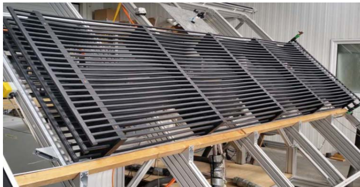
Abbildung 3-1: Absorber vom Typ Charger in 2-lagiger Ausführung auf dem Indoor-Prüfstand für Sonnenkollektoren
