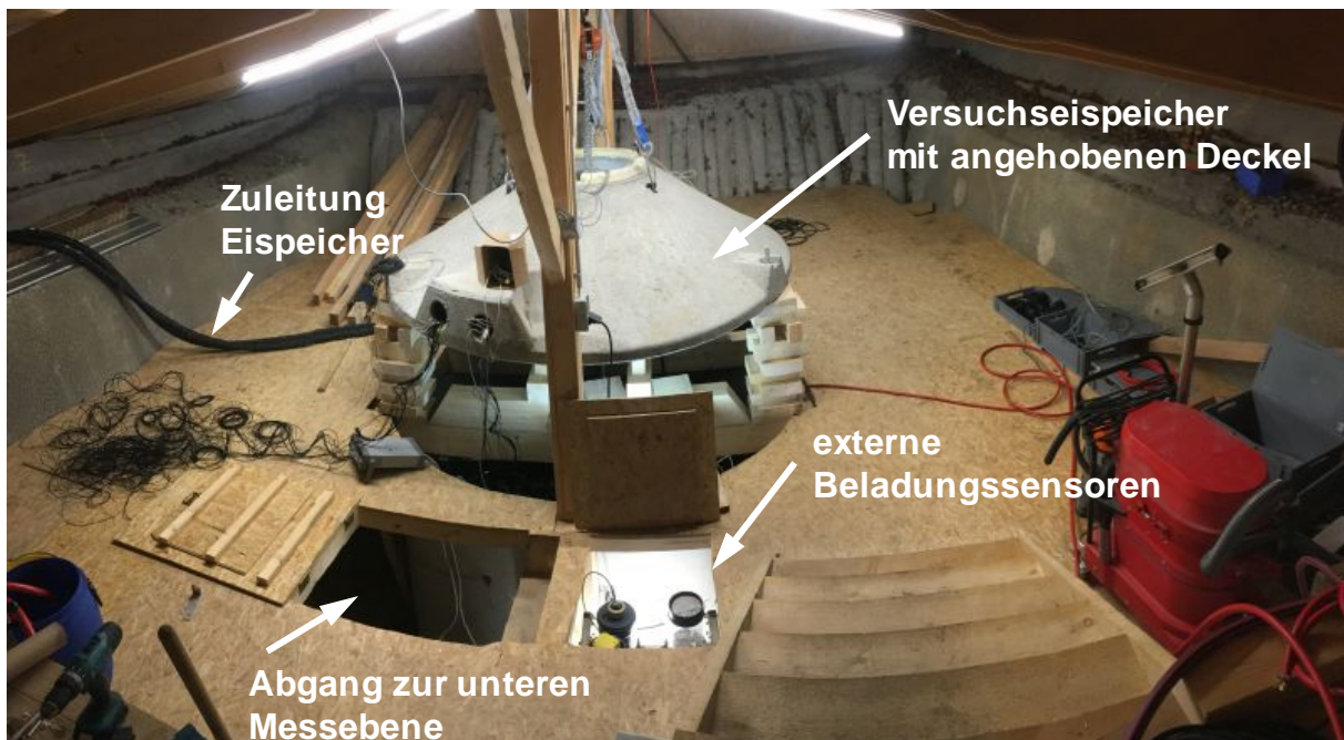
Abbildung 2-135: Aufbau Versuchsspeicher: Außenansicht mit angehobenem Speicherdeckel, umgebender Arbeitsplattform und Zugang zu den extern angebrachten Beladungssensoren.
