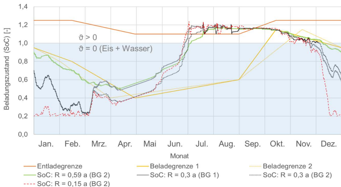
Abbildung 4-43: Saisonaler Verlauf des Beladungszustands bzw. „State of Charge“ (SoC) für unterschiedliche Verhältnisse der Wärmekapazität des Eisspeichers zum Heizenergiebedarf ( R = 0,59 a , R = 0,3 a und R = 0,15 a ) und zwei unterschiedliche saisonale Verläufe der Beladegrenze (BG 1 und BG 2) bei R = 0,3 a . Der Gesamtkühlbedarf wurde ebenfalls mit gleichem Faktor des Heizbedarfs skaliert.
