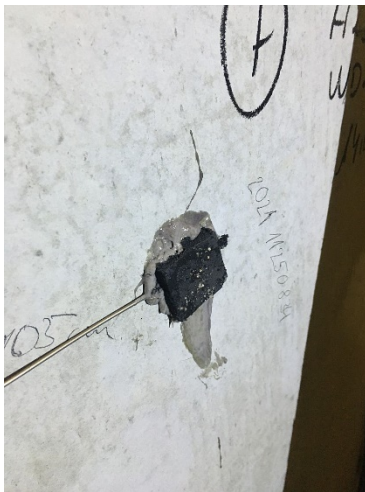
Abbildung 2-138: Temperaturfühler zur Messung der Außenwandtemperatur im Bereich des Speichermantels (links) und zur Messung der Innenwandtemperatur auf der Innenseite des Speicherbodens (rechts)
