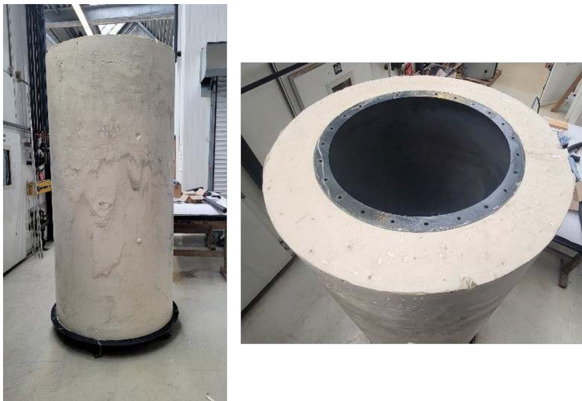
Abbildung 2-65: Manteldämmung der Wärmedämmung 2 am Innenzylinder des geöffneten Formwerkzeugs. Links: Vorderansicht; rechts: Ansicht von schräg oben
