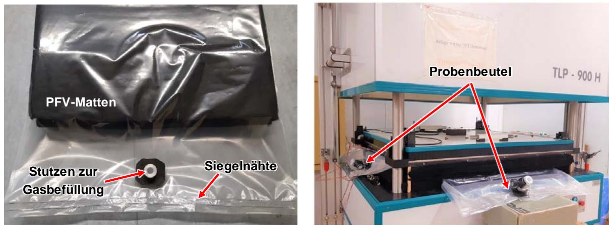
Abbildung 2-12: PFV-Proben zur Messung der effektiven Wärmeleitfähigkeit in unterschiedlicher Gasatmosphäre. Links: Aufbau Probenbeutel; rechts Einbau der Probenbeutel in einer Zweiplattenapparatur zur Messung der effektiven WLF.
