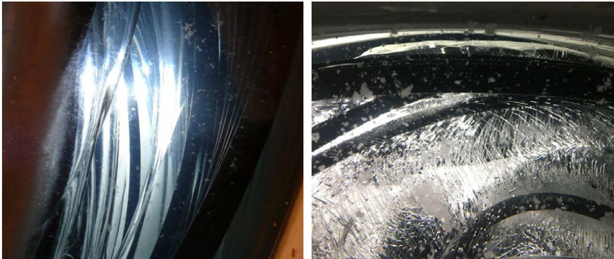
Abbildung 2-160: links: kristallklares Eis am Anfang der Entzugsphase und rechts: mit Luftblasen durchsetztes Eis am Ende der Entzugsphase.
