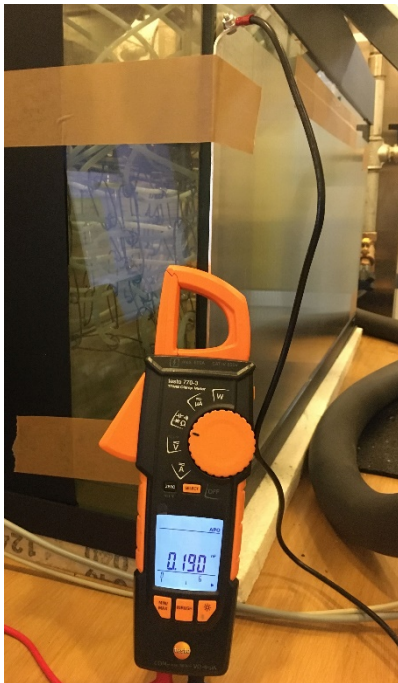
Abbildung 2-87 : links: Versuchsaufbau zur Messung der elektrischen Kapazität am Modelleisspeicher; rechts: Bestimmung der Wasserstandshöhe in Abhängigkeit von der elektrischen Kapazität
