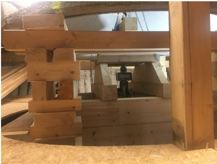
Abbildung 2-136: Tragstruktur für die Wägung der am Entzugswärmeübertrager anhaftenden Eismasse zur Bestimmung der wahren Eismasse am Ende der Entzugsphase.
