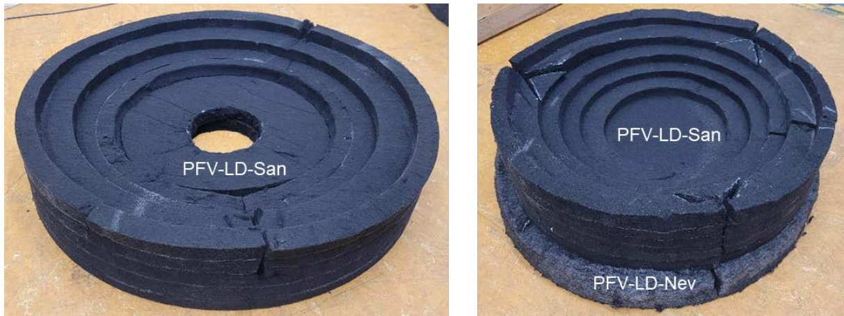
Abbildung 2-69: Deckeldämmung (links) und Bodendämmung (rechts) aus PFV-LD-San. Zur Ergänzung der Deckeldämmung werden noch weitere lose Kreissegmente aus PFV-LD-San aufgelegt. Die Bodendämmung wurde unten noch um ein Element aus PFV-LD-Nev ergänzt, um Hohlräume zuverlässig zu vermeiden
