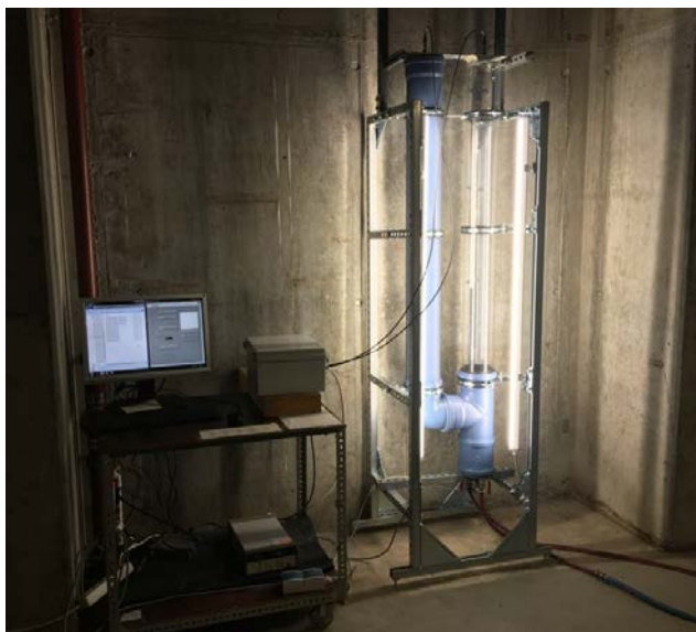
Abbildung 2-91: Pegelprüfstand zur Bestimmung der Messunsicherheit von Sensoren zur Bestimmung des Beladungszustandes von Eisspeichern, die auf einer Messung der Änderung der Höhe des Wasserstands basieren
