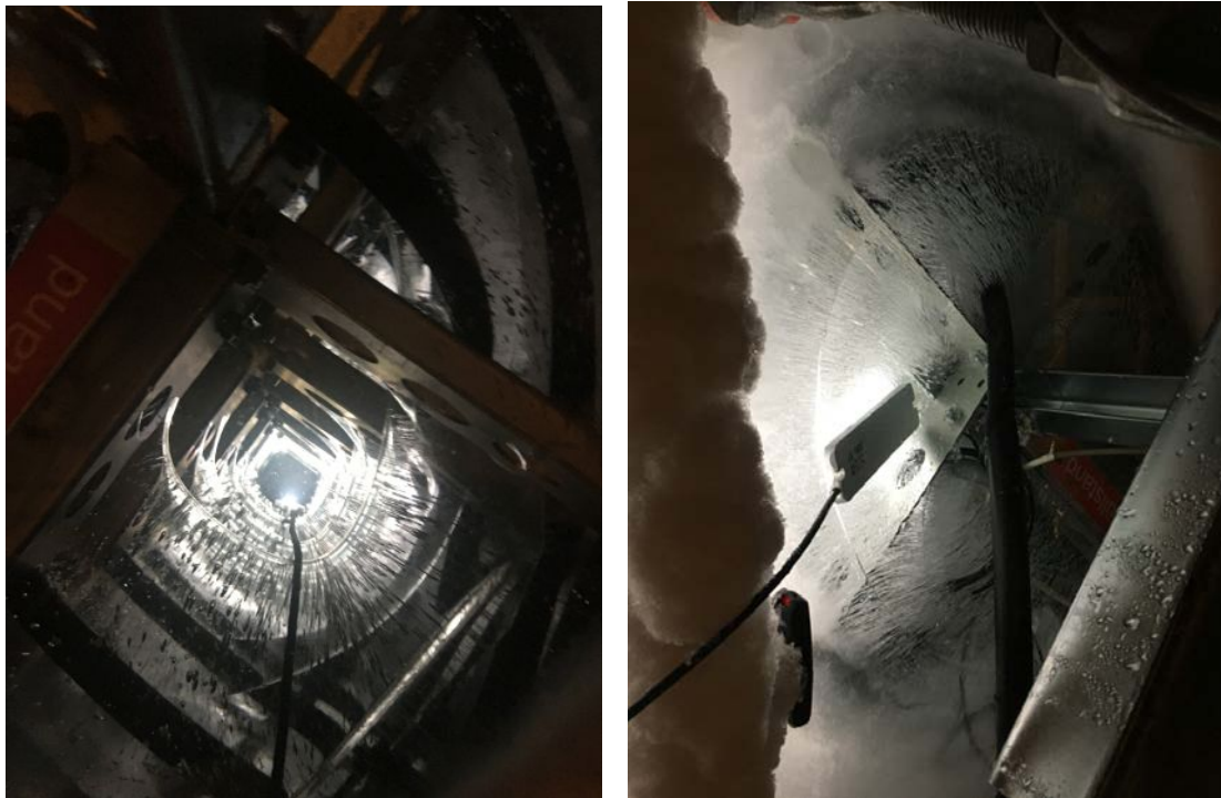
Abbildung 2-162: links: Eisformation in Bereich der Speichermitte des Speichers – 2 Tage vor Beendigung des Entzugs ist noch flüssiges Wasser vorhanden. Rechts: 2 Tage später am Ende der Entzugsphase ist der Bereich in der Speichermitte vollständig zugefroren.
