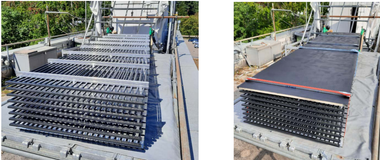
Abbildung 3-2: Absorber vom Typ Charger in 8-lagiger Ausführung ohne Abdeckung links, mit Abdeckung rechts auf dem Outdoor-Prüfstand für Sonnenkollektoren
