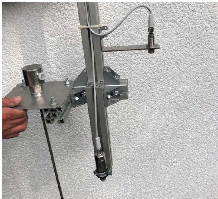
Abbildung 4-34: Sensoren zur Bestimmung des Beladungszustands vor dem Einbau in den Eisspeicher (links: Stabsonde mit geführter Mikrowelle, Mitte unten: Kapazitiver Pegelgeber, rechts: Ultraschall-Füllstandsensor)
