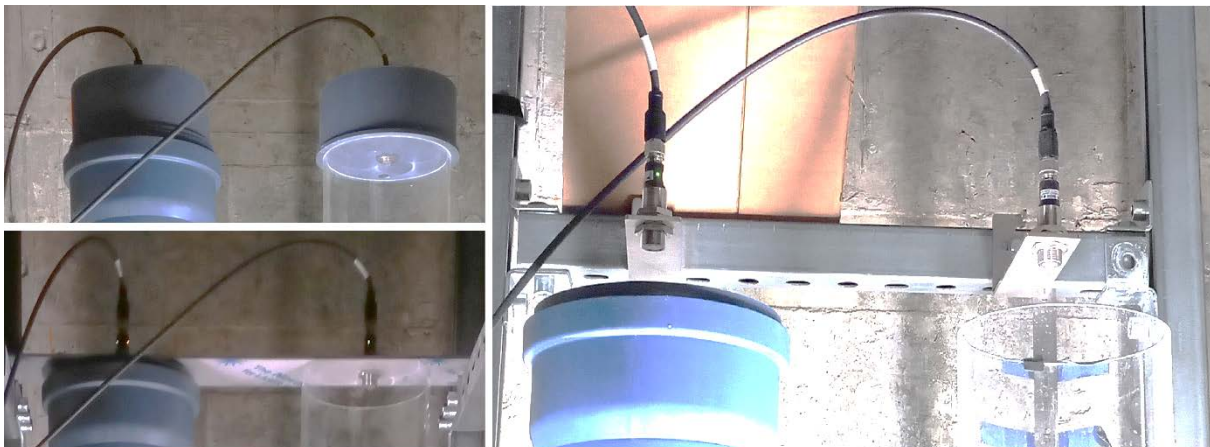
Abbildung 2-92: Befestigung der Sensoren in geschlossenen Deckeln (a) (links oben), in Aluminiumblech mit Abstand (b) (links unten) und in Stahlwinkeln mit Abstand (c) (rechts).
