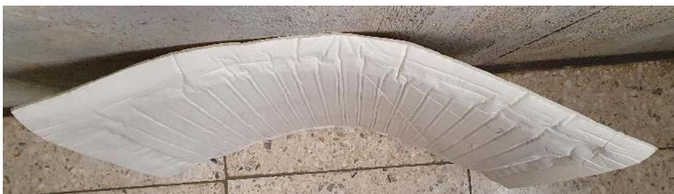
Abbildung 2-21: „va-Q-patch“ (VQP). Biegbares, in PE-Schaum kaschiertes VIP des Herstellers va-Q-tec.
