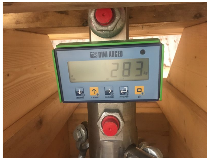
Abbildung 2-137: Kraftsensoren zur kontinuierlichen, indirekten Bestimmung der Eismasse (links) während der Entzugsphase und Kranwaage zur Bestimmung der wahren Eismasse am Ende der Entzugsphase (rechts).
