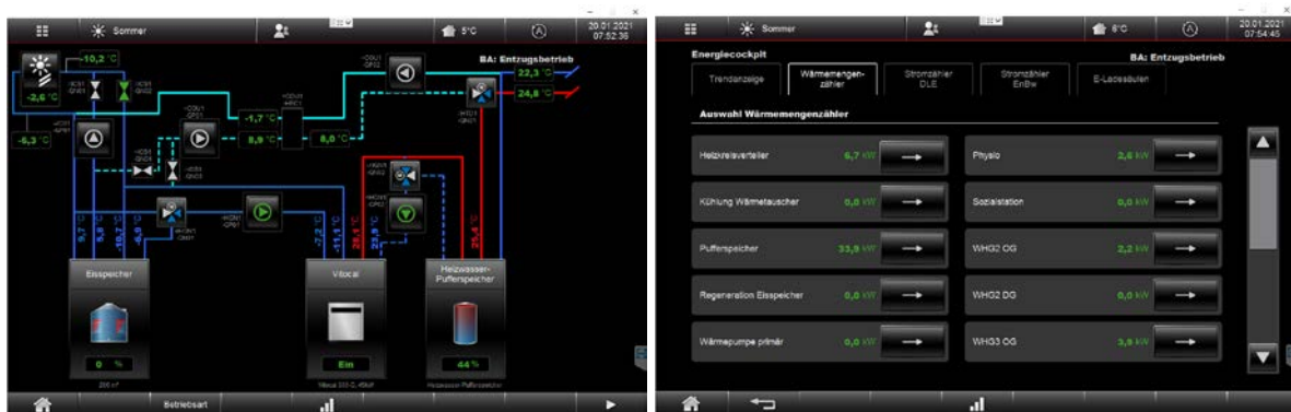
Abbildung 4-29: Visualisierung des Anlagenschemas im Bedienpanel der Regelung (links) und der von den Wärmemengenzählern ausgegebenen Leistungen (rechts) der Anlage 1
