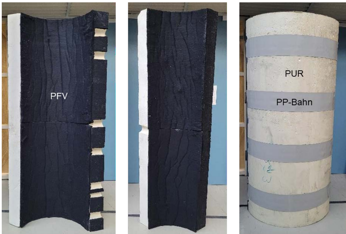
Abbildung 2-67: Manteldämmungssegmente der Wärmedämmung 2 mit PFV-LD-San und Streifen aus PP
