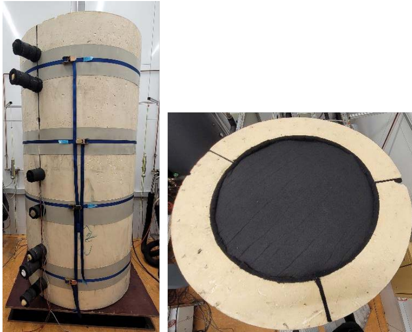
Abbildung 2-71: Wärmedämmung 2 mit Deckeldämmung aus PFV-LD-San am Prototyp-Speicher während der Messung der Warmhalteverluste nach DIN EN 12897:2020. Links: Vorderansicht; rechts: Ansicht Deckeldämmung
